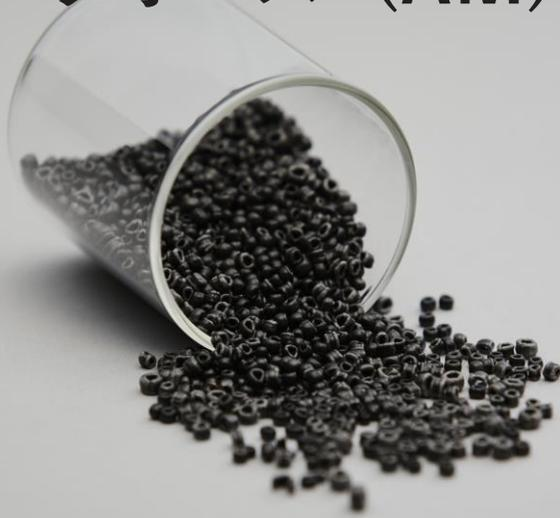
サンフォース®(AM)は、ポリアミドの長所に加え、発泡体の長所を併せ持つ材料です。
