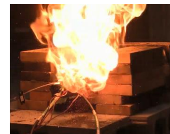
LiBセル発火試験にて類焼遅延効果確認
