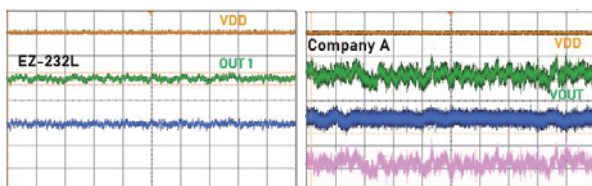
競合コアレス電流センサとのノイズ比較
