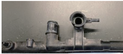
市場回収品ラジエータータンク (PA66 + GF30%)
