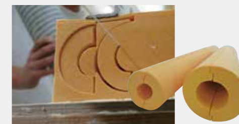
切り出し加工(パイプカバーの例)
