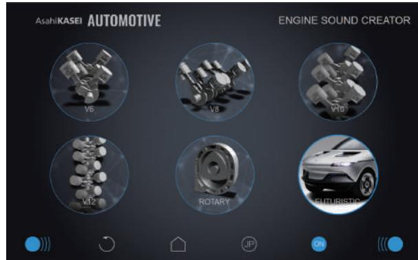
エンジンサウンドクリエイター(ESC)はEVにエンジン音を搭載できます。例えば、スポーツカーの迫力あるエンジン音や、EVにマッチした未来を感じさせる電子音(未来的創造音)を車速やアクセル開度に合わせて気持ちよく響かせます。EVでは音による加速感を感じにくくなるため、ESCを搭載することにより、聴覚での加速感も備わり、安全で快適なドライブを楽しむことができます。
